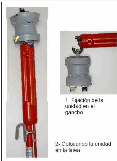
Instalación con pértiga
